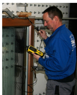
Ein Mitarbeiter der Qualitätssicherung prüft eine Fenster auf Luft- und Schlagregendichtheit.
