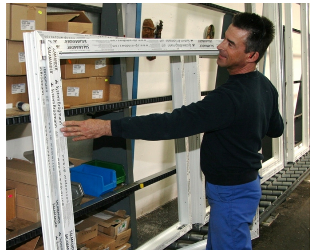
Ein Mitarbeiter hängt einen Fensterflügel in den Rahmen ein.
