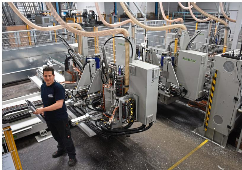
Die Fertigung beim Schock Fensterwerk strotzt nur so von Hightech-Maschinen. Hier werden unter hoher Temperatur die einzelnen Kunststoffteile zu einem Fensterrahmen zusammengefügt. In den Ausstellungsräumen des Unternehmens in Ingolstadt (unten) kann sich jeder Kunde von der Vielfalt und dem großen Leistungsspektrum des Unternehmens überzeugen. Fotos: Bartenschlager
